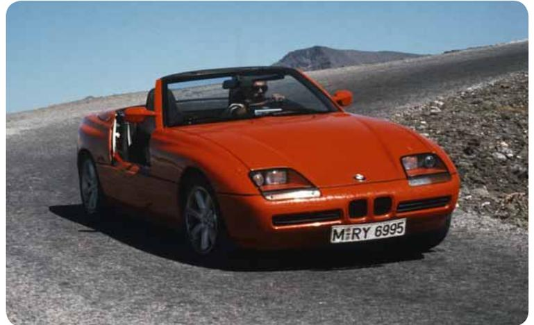
**BMW Z1** 8.000 Exemplare produzierten die Münchner zwischen 1989 und 1991. Innovation: Per Zahnriemen versenkt der Fahrer die Türen des Z1 in den Seitenschwellern.
