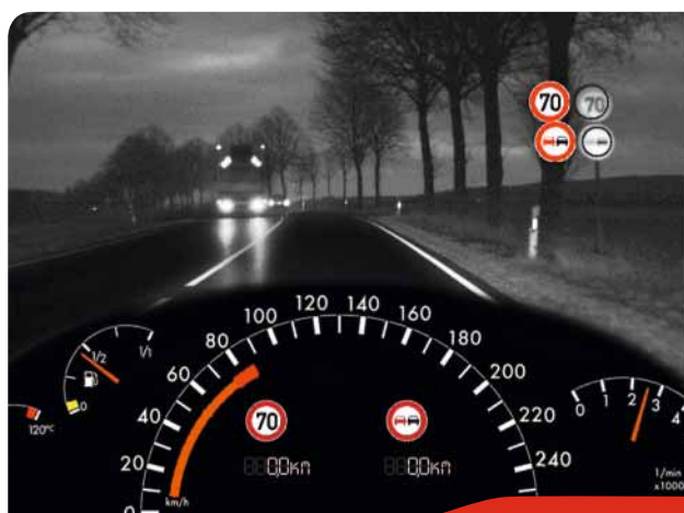
† Das Infrarot-Nachtsichtsystem „Night Vision“ kann in der Dunkelheit u. a. Verkehrsschilder erkennen und deuten
